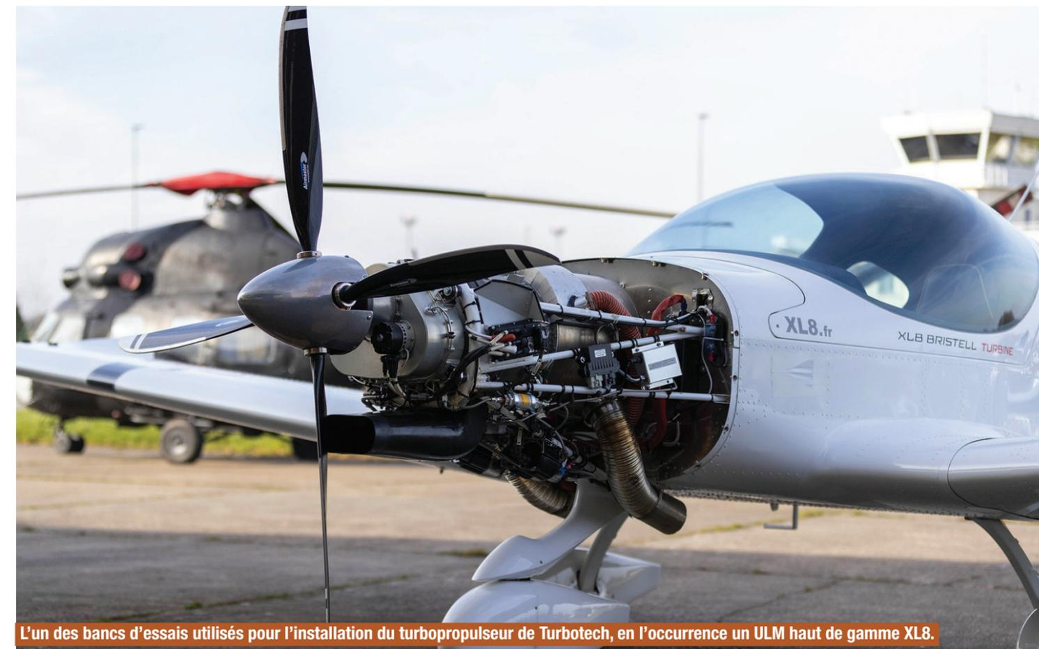
L'un des bancs d'essais utilisés pour l'installation du turbopropulseur de Turbotech, en l'occurrence un ULM haut de gamme XL8.
